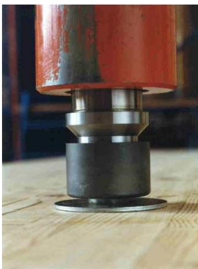
Optrompen van de buis met sluitring
