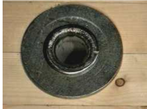
Close-up van de buis met sluitring na expansie
